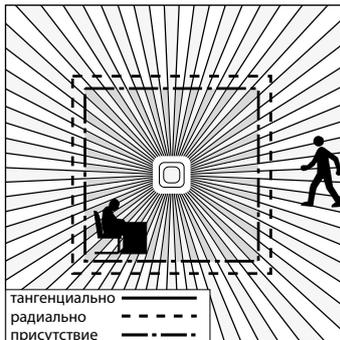
64 м<sup>2</sup> с более 4800 зонами переключения уточняет спектр охвата. Благодаря настройке на потенциометре существует возможность привести оба этих радиуса действия в соответствие индивидуальным потребностям. Благодаря квадратной зоне охвата можно просто, быстро и оптимально спланировать помещение.
